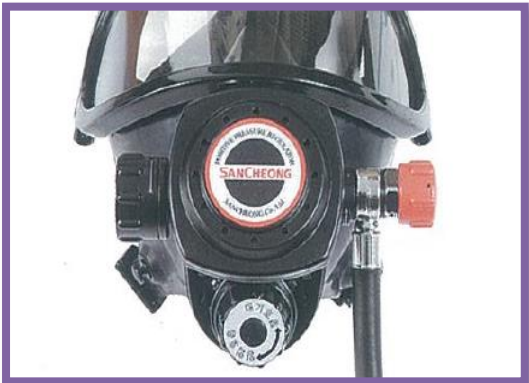
1. 양압 조절기 핸들을 "close"에 두고 By-pass 밸브가 잠겨 있는지 확인한다.
