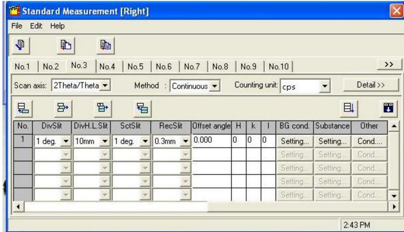
DivSlit (Divergence Slit)과 ScaSlit(Scattering Slit)은 X-ray Beam Depth를 의미한다. 두 slit은 항상 동일한 값을 입력해준다.
